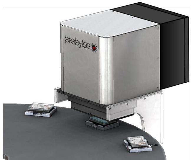
Beim Schweißen von zwei Bauteilen wird der Kunststoff an den zu verbindenden Oberflächen aufgeschmolzen und zusammengedrückt, so dass sich der flüssige Kunststoff beider Teile mischt. Beim Abkühlen erstarren die Kunststoffschmelzen und ergeben eine feste Verbindung. Damit ein Schweißen möglich ist, müssen die beteiligten Kunststoffe unter Wärmeeinwirkung schmelzen (Thermoplaste) bevor sie degradieren oder sich zersetzen (Duroplaste).
