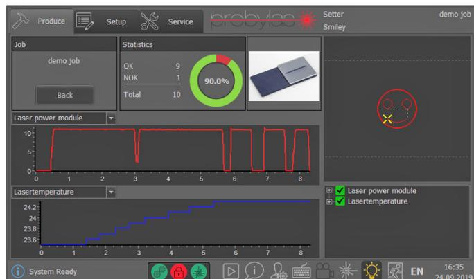
Ansicht für den Operator bei Serienproduktion
