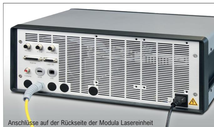
Anschlüsse auf der Rückseite der Modula Lasereinheit
